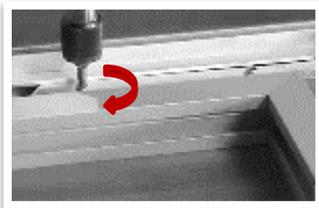
Legen Sie den Rahmen auf einen flachen Untergrund und ziehen Sie mit Hilfe des Inbusschlüssels die Schrauben aller Eckwinkel fest.
