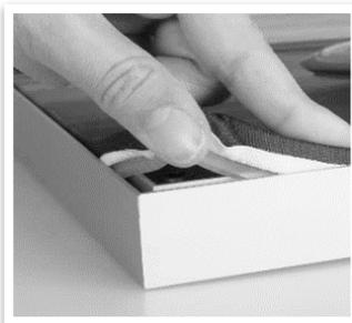
Fügen Sie das Textil mit dem Keder in die dafür vorgesehene Nut des Rahmens ein. Achten Sie darauf, den Keder richtig zu halten, da das Textil sonst nicht in den Rahmen passt: Klappen Sie den Keder leicht (90°) nach innen und stecken ihn in die Nut (siehe Bild).
