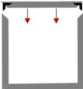
Das letzte Profilstück (mit Deckenhängern) versehen Sie mit den 2 übrigen Eckwinkeln und schieben es auf die 3 bereits zusammen gebauten Profilstücke.
