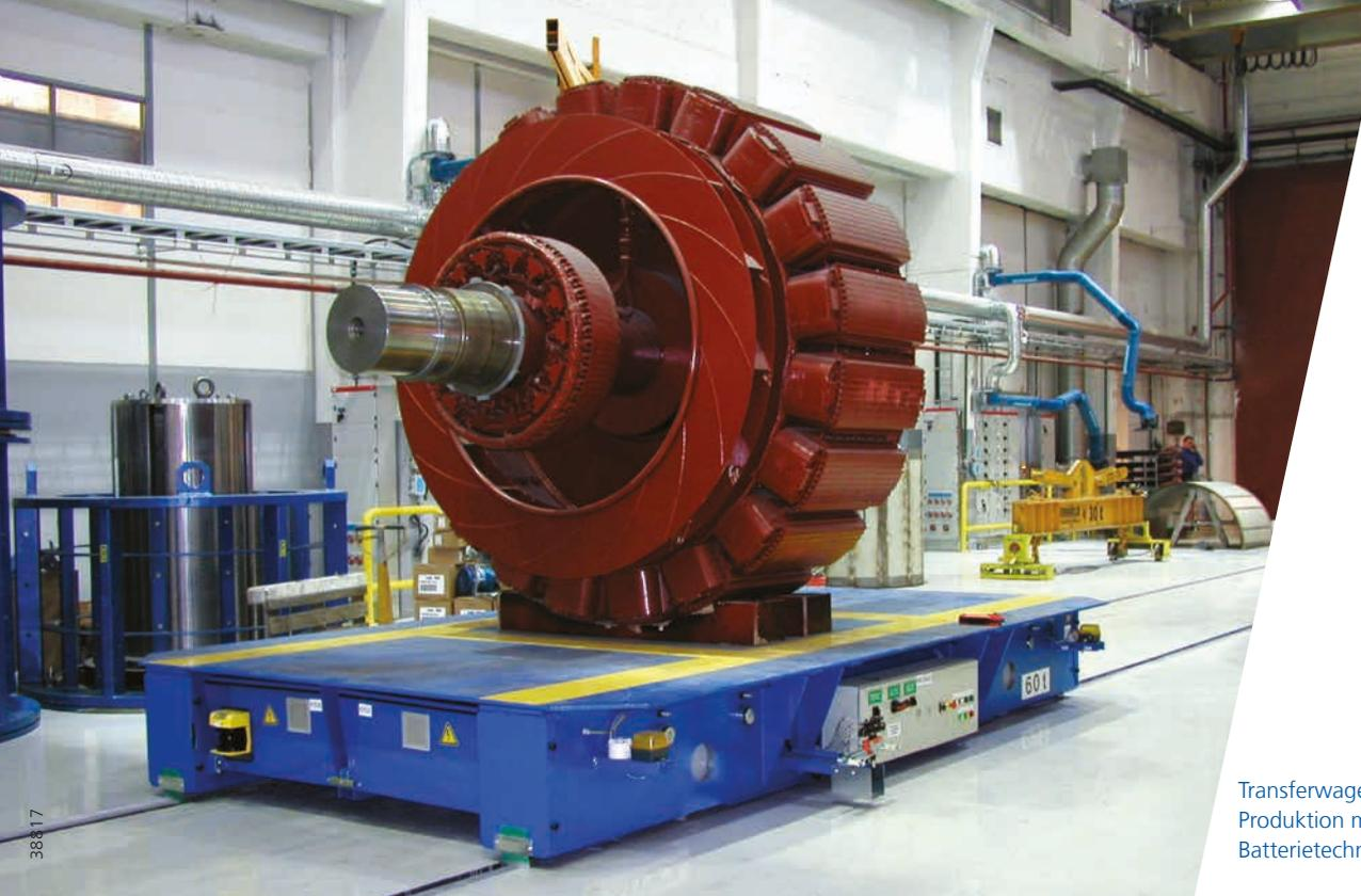
Transferwagen in der Produktion mit Batterietechnik
