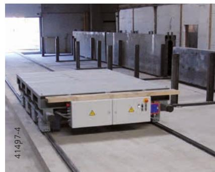
Die Onboard-Ladeeinheit sorgt für die Aufladung der Batterie in der Versorgungszone. Die Leistungseinheit wandelt den Batteriegleichstrom in Verbindung mit dem Frequenzumrichter Dedrive Compact STO in Drehstrom und versorgt die Antriebe mit der nötigen Energie und
