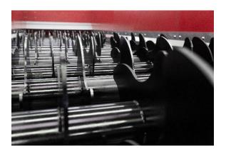
Bei der Zuführung fällt der Großteil des Kleinstmaterials direkt durch die Siebeinheit auf ein darunterliegendes Abfuhrband. Durch die abgerundeten Sternscheiben wird das auszusiebende Material im weiteren Verlauf über das komplette Siebdeck zu einem anschließenden Abfuhrband befördert. Dabei fallen sowohl sämtliche Papieranteile (z.B. Zeitungen, Illustrierte, Prospekte, etc.) wegen ihrer geringeren Steifheit, als auch kleinere Kartonagestücke zwischen den Wellen hindurch auf das Abfuhrband.
